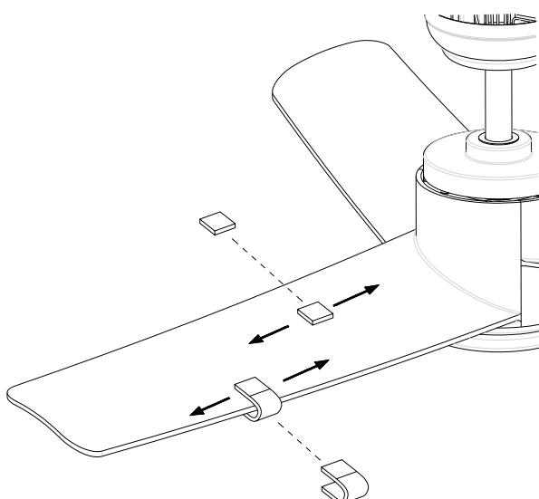
Porniți ventilatorul și setați viteza (de obicei, viteza mare) care provoacă cea mai gravă oscilație. Opriti ventilatorul. Îndepărtați o lamă și puneți pe ea o clema de echilibrare. Porniți din nou ventilatorul și observați dacă oscilația s-a îmbunătățit sau s-a înrăutățit.
