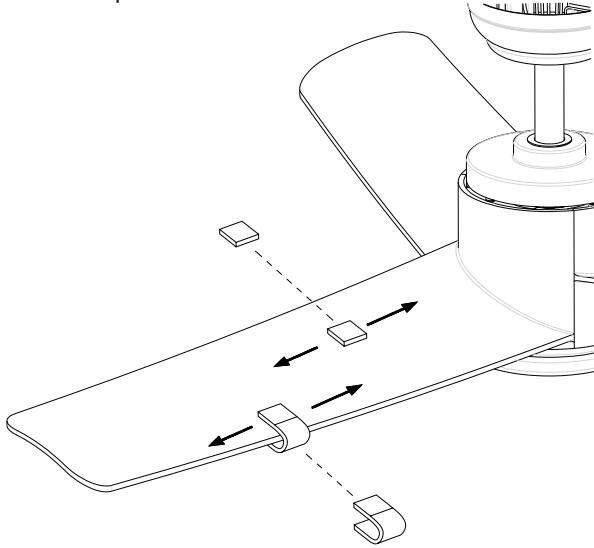
Porniți ventilatorul și setați viteza (de obicei, viteza mare) care provoacă cea mai gravă oscilație. Opriti ventilatorul. Îndepărtați o lamă și puneti pe ea o clema de echilibruare. Porniți din nou ventilatorul și observați dacă oscilația s-a îmbunătățit sau s-a înrăutățit.
