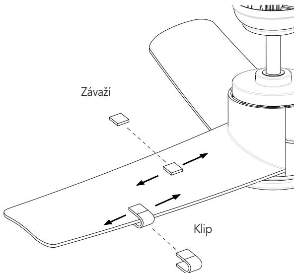
Zapněte ventilátor a nastavte rychlosť (obvykle vysokou), která způsobuje nejhorské kmitání. Vypněte ventilátor, vyberte jednu lopatku a nasadte na ni využovací klip. Ventilátor znova zapněte a sledujte, zda se oscilace zlepšila nebo zhoršila.
